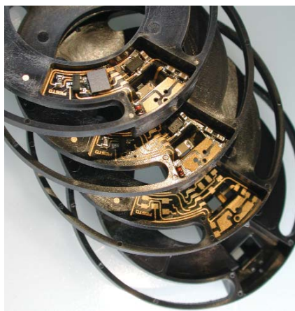
Abb. 2: Drehwinkelsensorgehäuse vom Kunststoffrohling (unten) zum fertig bestückten MID (oben)
