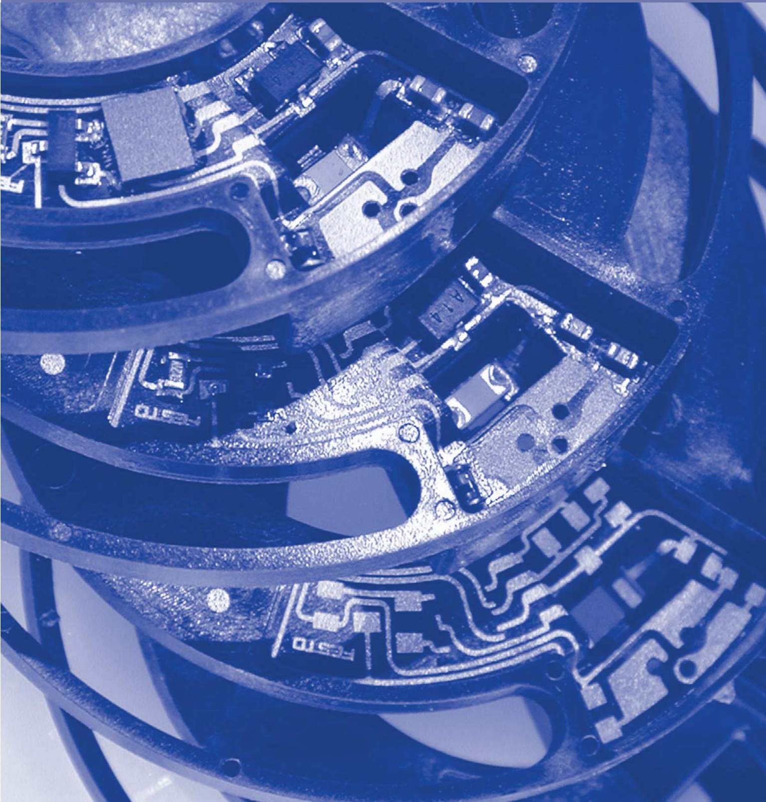
Drehwinkelsensorgehäuse vom Kunststoffrohling (unten) zum fertig bestückten MID (oben)
