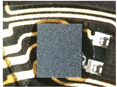
Abb. 4: Mit NCA gebondeter Flipchip auf dem Drehwinkelsensorgehäuse
