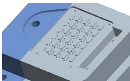
Abb. 4: CAD-Konstruktion der Einsätze
