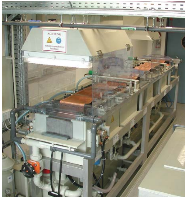
Abb. 1: Anlage im HSG-IMAT zur Herstellung von Heißprägefolien mit haftvermittelndem Treatment und OSP
