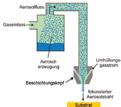
Abb. 1: Schematische Darstellung des M 3 D-Verfahrens
