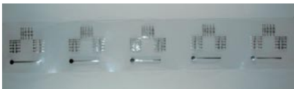
Abb. 2: Flexibler Schaltungsträger mit Leiterbild in Nutzenanordnung
