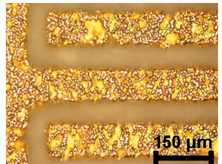
Abb. 4: Kammstruktur mit sehr feinem Pitch
