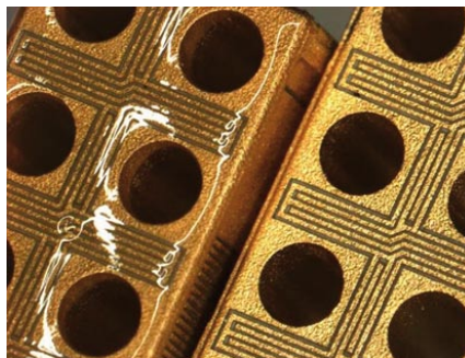
Abb. 6: Sensor mit und ohne Schutzlack
