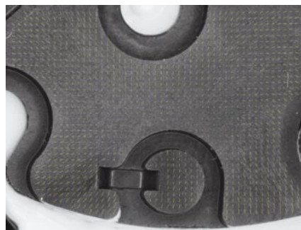
Abb. 4: Verformungsanalyse an einem Spritzgießbauteil mit Grauwertkorrelation
