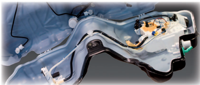
Kraftstofftank mit Pumpen, Leitungen und fluidischen Schnellkupplungen Quelle: Inergy Automotive Systems, Internetpräsenz
