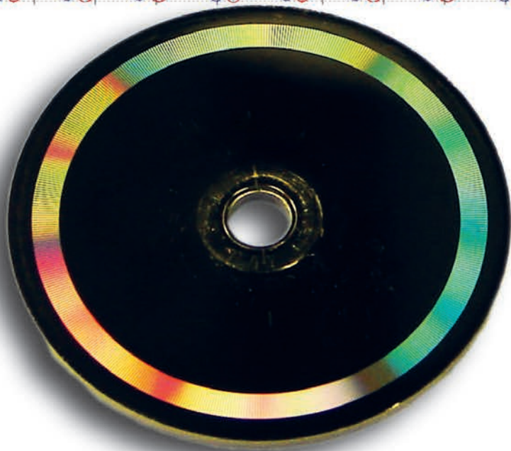
Kodierscheibe und Abtasteinheit des Drehgebers
