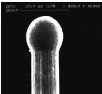
Bild 5: Taststift und Tastelement
