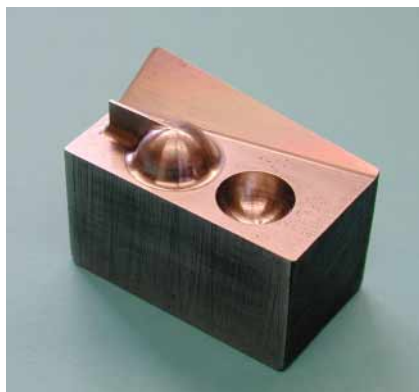
Bild 3: Probewerkstück aus Werkzeugstahl mit HRC64 zur Auswahl der Maschine.
