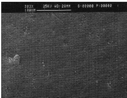
Bild 3: REM-Aufnahme von NBR 70 Sh. unbehandelt
