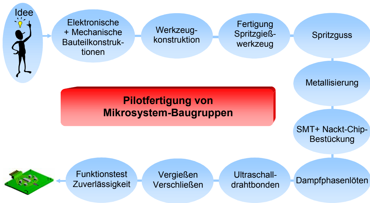
Bild 2: Durchgängige Entwicklung und Herstellung von Mikrosystem-Baugruppen in MID-Technik
