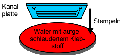
Bild 4: Prinzip des Klebstoff-Transfer-Verfahrens
