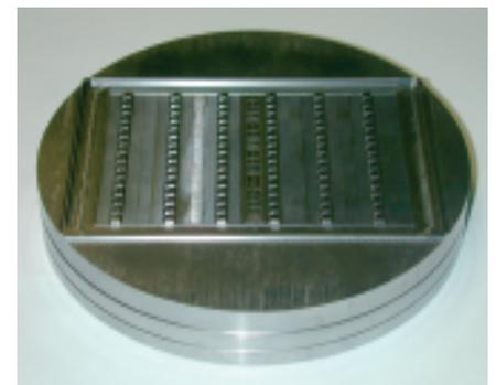
Abb. 4: Formeinsatz aus Stahl für die Herstellung eines Dosierchips mit bis zu 384 Dispensereinheiten
