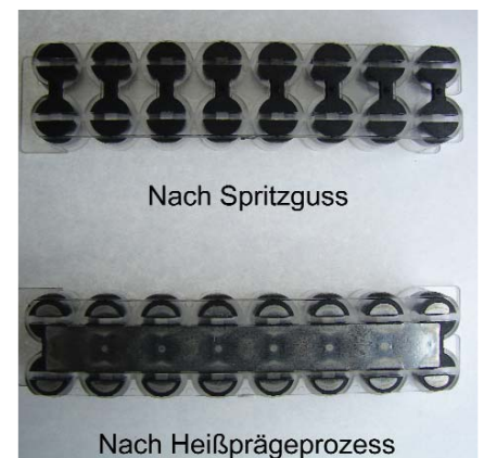
Abb. 2: MID-Bauteil - Unterseite vor (oben) und nach dem Heißprägeprozess (unten)
