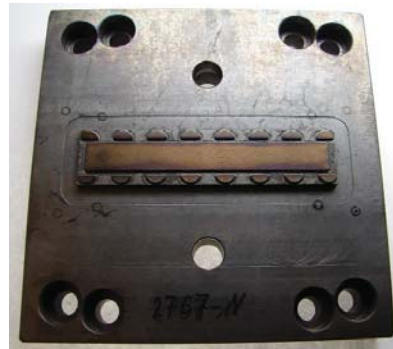
Abb. 4: Heißprägestempel zur Herstellung des MID-Bauteils
