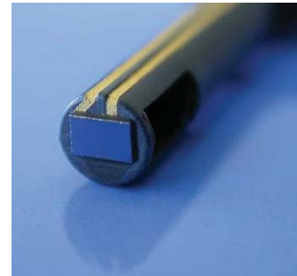
Abb. 4: Flip Chip auf LDS-MID, von der Robert Bosch GmbH auf Zuverlässigkeit geprüft
