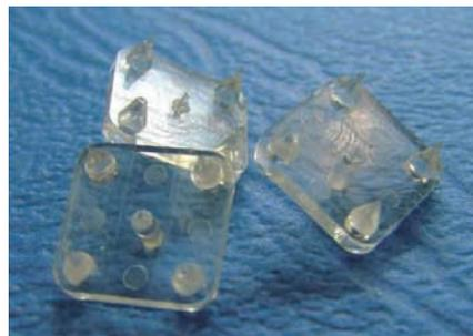
Abb. 5: Spritzgegossene Mikronadel-Arrays
