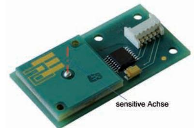
Abb. 1: 360° Neigungswinkelsensor mit Elektronik
