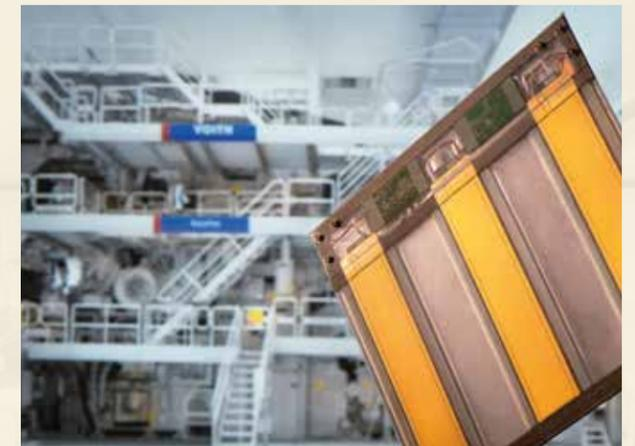
Verluste, die durch notwendige anfallende Stillstandzeiten während der Vermessungsarbeiten entstehen, werden dadurch minimiert. Die Kommunikation zwischen PC und den Einzel-Sensorarrays zur Steuerung und Erfassung erfolgt über ein Standard-WLAN-System.
