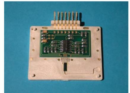
Bild 2: 2K-MID für Durchfluss-Sensorsystem
