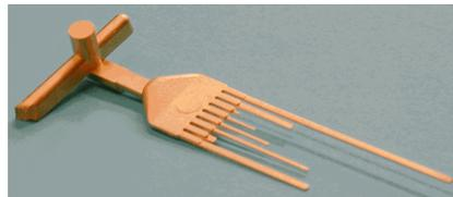
Bild 2: Metallisierter Spritzling mit verschiedenen Balken für Drei-Punkt-Biegeversuch
