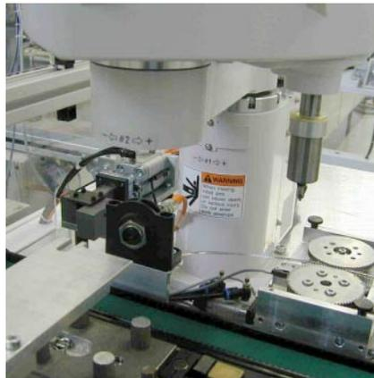
Bild 4: Kontaktbestückungsmodul
