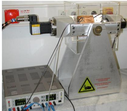
Bild 5: Neigungssensor-Prüfstand
