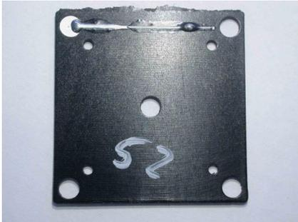
Bild 4: Geringe Flussmittelreste der Lotpaste (SC 150, Solder Chemistry) nach dem Dampfphasenlötprozess
