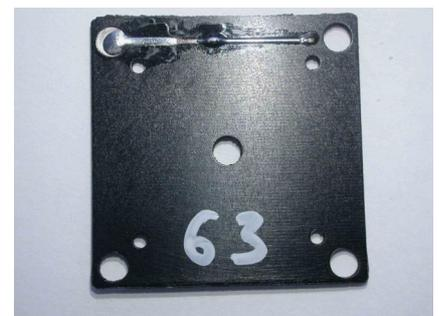
Bild 3: Lotpaste mit großer Menge an Flussmittelresten nach dem Dampfphasenlötprozess
